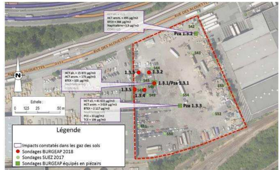
Figure 181 : Localisation des piézairs et synthèse des impacts dans les gaz des sols
