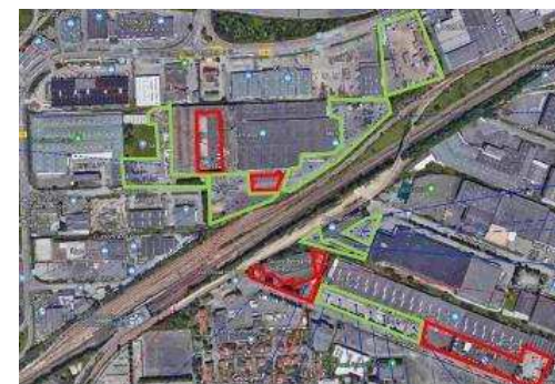
Figure 174 : Localisation des zones amiantées et non amiantées (légende : rouge : zone amiantée, vert : zone déclassée, flèches : point de prélèvement)
