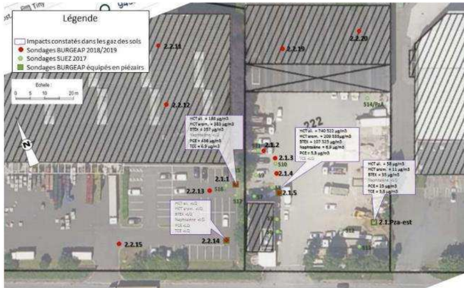
Figure 182 : Localisation des piézairs et synthèse des impacts dans les gaz des sols des lots 2.1 et 2.2
